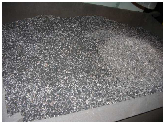
砂再生機から分別された小豆大の砂塊(右は拡大写真)
