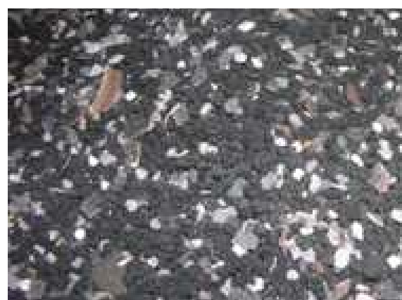
砂再生機から分別された小豆大の砂塊(右は拡大写真)
