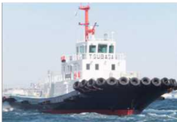
図3. リチウムイオン電池ハイブリッドタグボート「翼」 図4. 電池無しハイブリッドタグボート「銀河」
