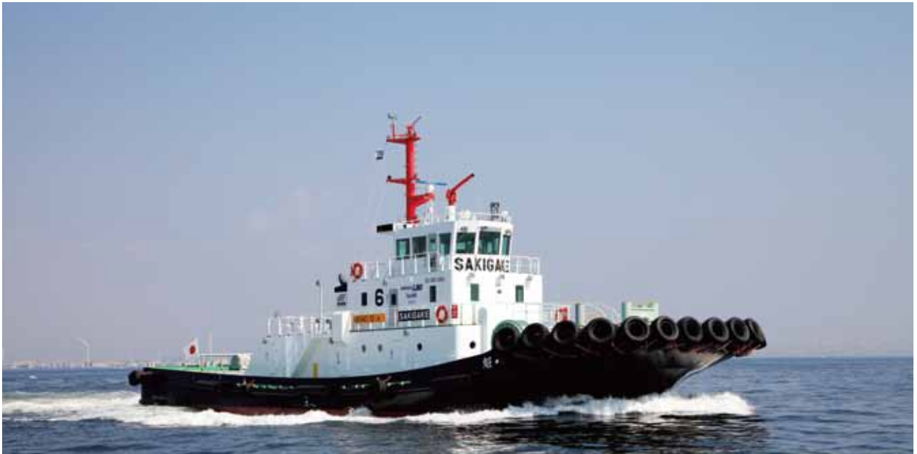
国内初の LNG 燃料タグボート「魁（さきがけ）」
