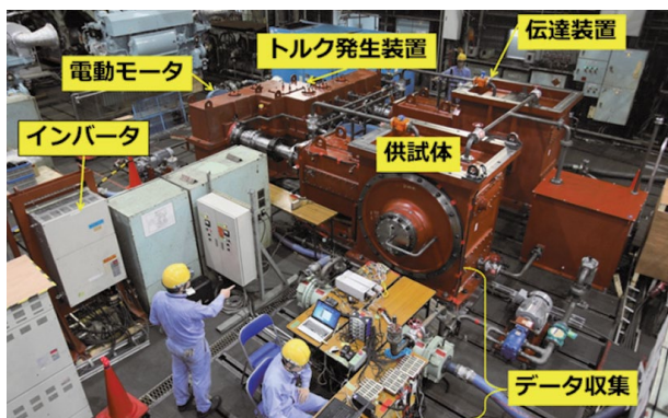
動力循環式実負荷試験装置
