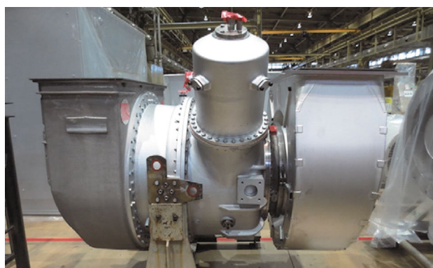
図1 ガスタービン外観
