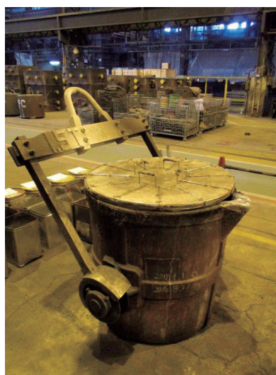
断熱蓋設置状況
