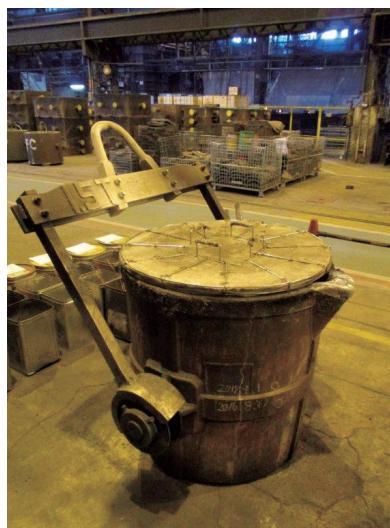
断熱蓋設置状況
