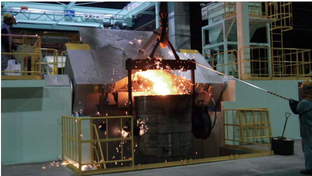
8 トン高周波誘導溶解炉 初出湯風景
