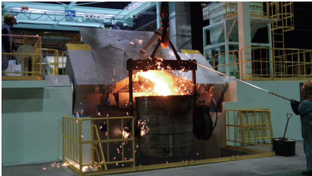
8トン高周波誘導溶解炉 初出湯風景
