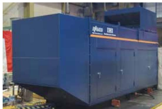
図2 新2000kVAガスタービン発電装置外観
