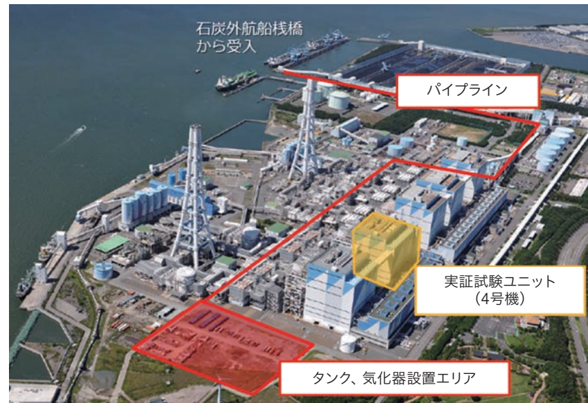
碧南火力発電所アンモニア燃焼実証事業 出典：株式会社JERA
