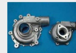
コンプレッサインペラを包み、空気の吸込み部分と吐出部分より構成される部品。コンプレッサインペラで圧縮された空気を吐出部分に導き、動圧を静圧に変換する機能を持つ。
