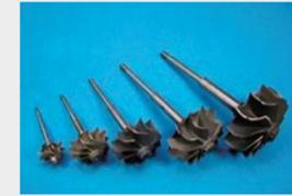
排気ガスを受ける複数の羽根(タービンホイール)部とコンプレッサに駆動力を伝えるシャフト(軸)部で構成される部品。エンジンからの排気ガスのエネルギーを回転運動に変換し、コンプレッサインペラを回転させる。
