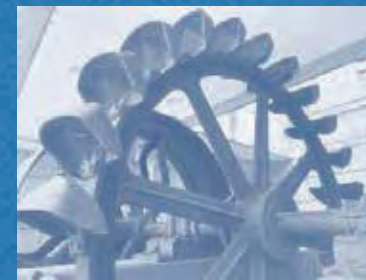
ペルトン水車 石川島造船所製作(1891年)
