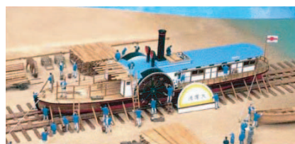
民間造船所初の蒸気船である 石川島平野造船所1番船「通運丸」
