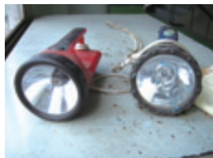
検査用懐中電灯 従来タイプ(左)とLEDタイプ(右)
