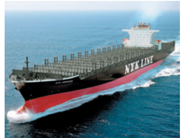
全長: 336.00m 幅: 45.80m 深さ: 24.40m 吃水: 14.00m 総トン数: 約99,000トン 載貨重量トン数: 約99,000トン
