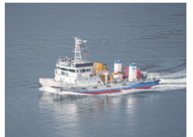
全長: 33.5m 幅: 11.6m 高さ: 4.2m 総トン数: 約198トン
