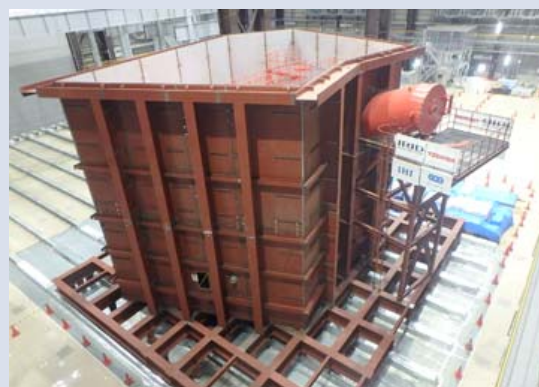
原子炉格納容器下部を模擬した実規模模擬試験体
