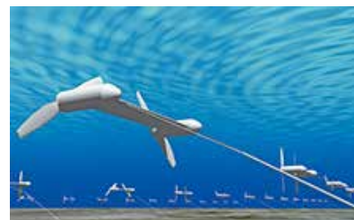
水中浮遊式海流発電システム 海中への設置イメージ
