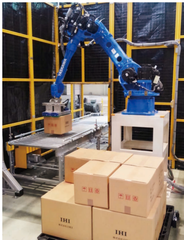
AI 搭載のデパレタイズシステム
