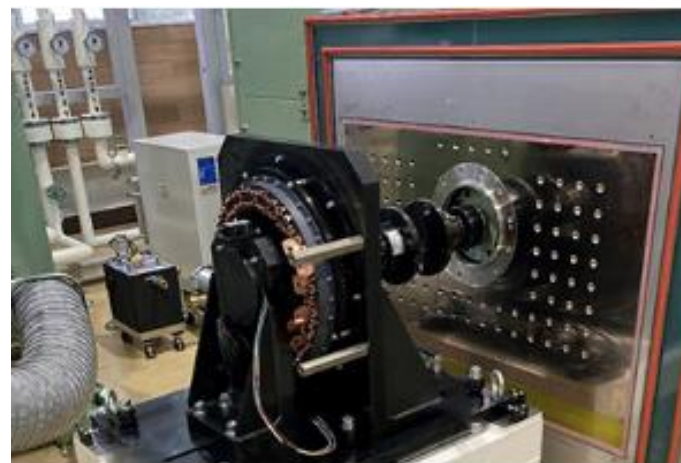
【第2図】出力250kW超試作機性能試験©秋田大学
