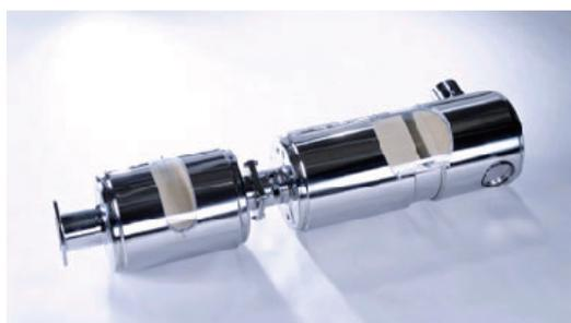
第 2 図 ディーゼル車搭載のアンモニア (尿素水分解) SCR 部 (中央部分) のカットモデル<sup>(9)</sup>
