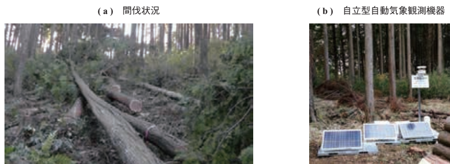
第 32 図 列状間伐の現場と設置した自立型自動気象観測機器 Fig. 32 Line thinning at forest site and installation of stand-alone meteorological observation equipment
