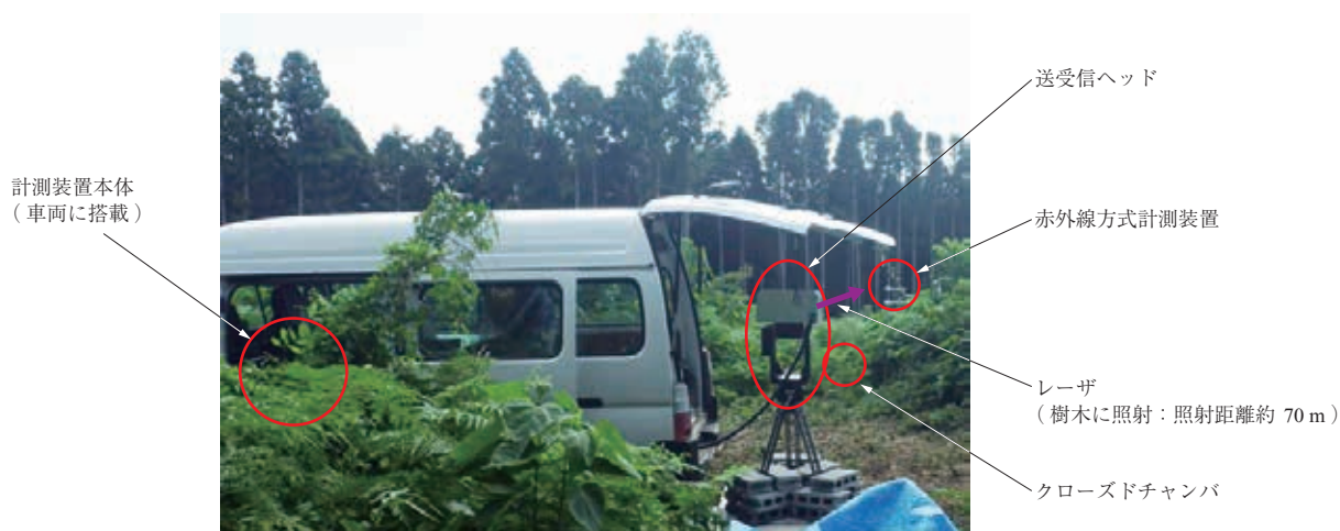
第 31 図 森林内での CO 2 レーザモニタリング試験 Fig. 31 CO 2 laser monitoring test in forest
