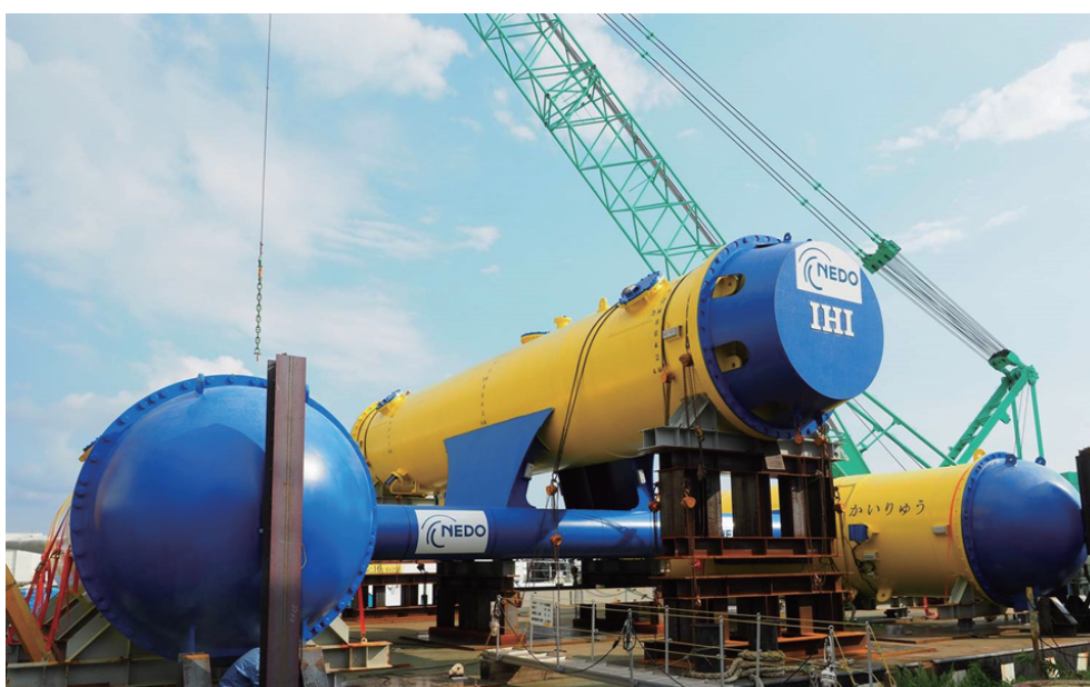
水中浮遊式海流発電システム 100 kW 級実証機「かいりゅう」
