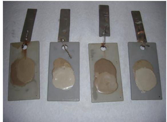
DBA 試験実施後の塗装試験片
