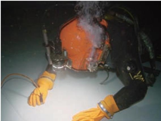
水中での超音波板厚計測
