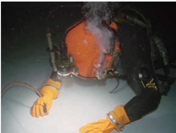
水中での超音波板厚計測
