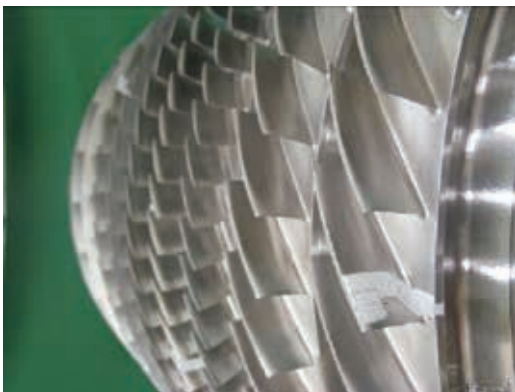
第7図 製作した圧縮機ロータアッセンブリ Fig. 7 Rotor assembly of nine-stage compressor
