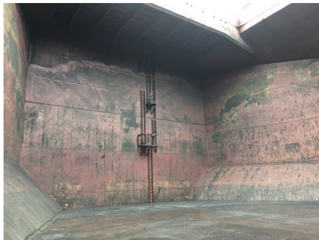
船倉内の障害物の例(階段部)
