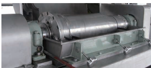
第 5 図 傾斜排液機構のテスト機の外観 Fig. 5 Test scene of slope release mechanism
