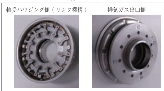
VGS : Variable Geometry System ターボチャージャーの構造
