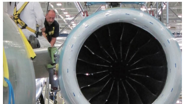
第 6 図 機体に搭載された GE Passport 20 エンジン Fig. 6 GE Passport 20 engine mounted on Global 7500 flight-test vehicle
