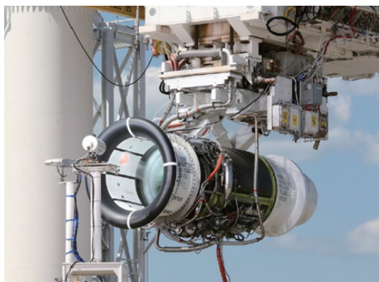
(a) 氷塊打ち込み試験
