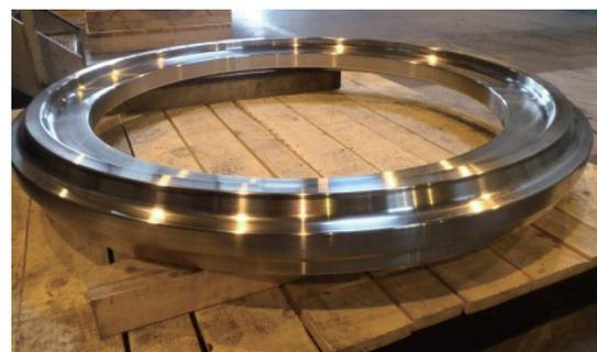
第 8 図 鍛造リング製造トライアル
