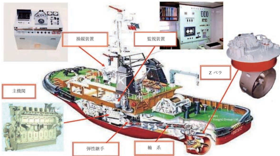
NPS の供給製品（タグボートの例）
