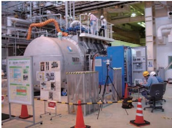
低温循環試験装置は量研機構現有システムに接続して運転・計測
