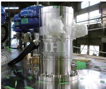
低温循環試験装置に設置した IHI 製ポンプ
