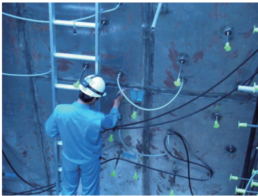
第8図 ヘリウムリーク試験（ベーパーバリア） Fig. 8 Helium gas leak test of vapor barrier
