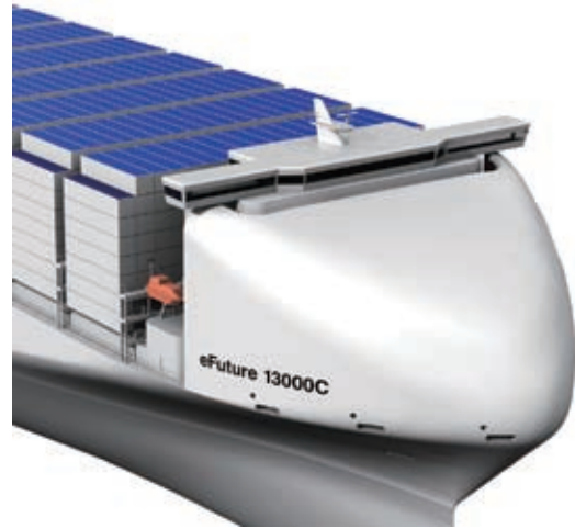
第 6 図 船首ブリッジと船首ボンネット Fig. 6 Forward bridge and bow bonnet
