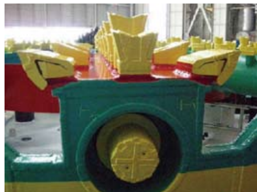
(b) 2 重ビット (取付状況)
