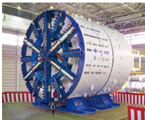
第 10 図 大和川線シールド シールド機全景 Fig. 10 Full view of Yamatogawa line shield
