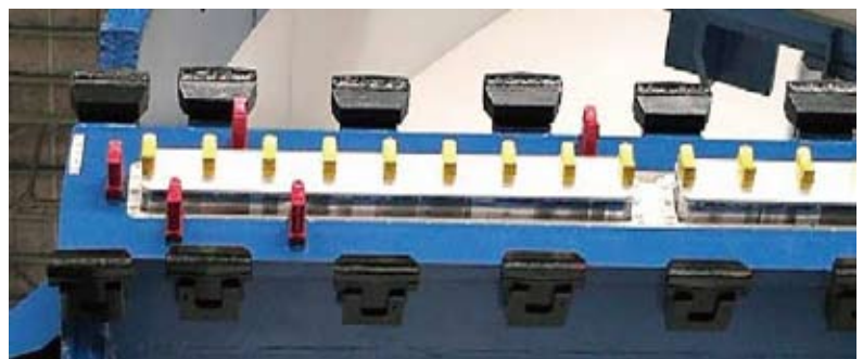
第13図 大和川線シールド 可動先行ビット Fig. 13 Movable precedential bit of Yamatogawa line shield
