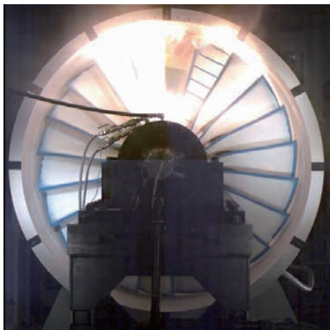
第 8 図 FBO 試験 Fig. 8 Containment rig test
