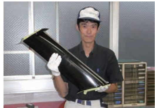
第 13 図 PW1100G-JM 複合材 SGV Fig. 13 PW1100G-JM composite SGV
