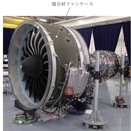
第 12 図 PW1100G-JM および複合材ファンケース Fig. 12 PW1100G-JM and composite fan case
