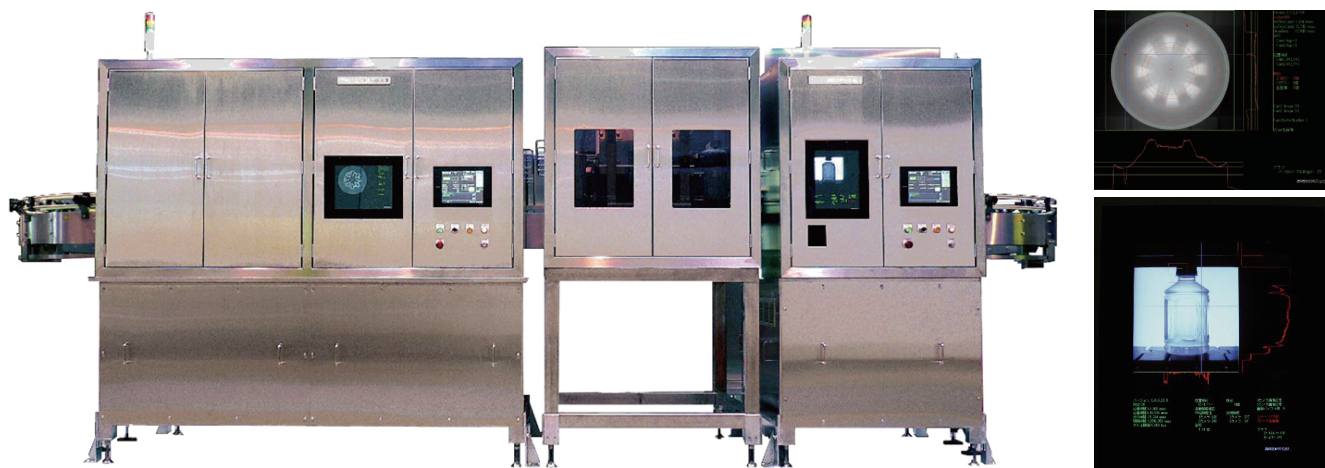
実びん異物検査システム (TGV30-10) と検査画像
