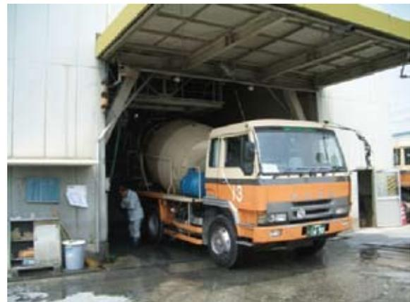
第 18 図 プラントでの製造とアジテータ車による運搬
