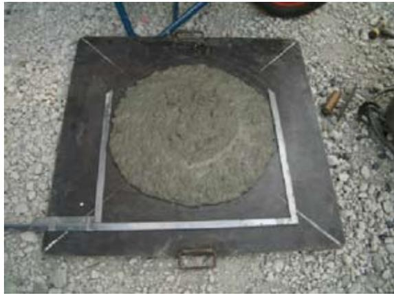
第 20 図 ベースコンクリートのスランプフロー (鋼繊維混入前)
