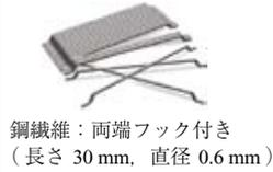
第 1 図 高強度繊維補強コンクリートと鋼繊維
