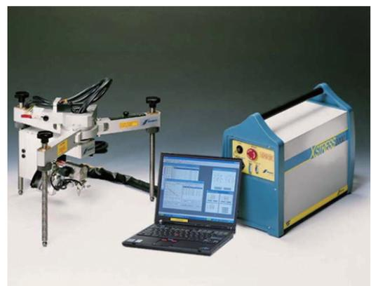
第4図 携帯型 X 線応力計測装置 (X3000)
