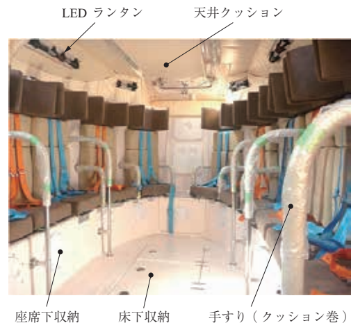
第 14 図 プロトタイプ艇の内部前方 Fig. 14 Internal view of the fore of the prototype tsunami lifeboat
