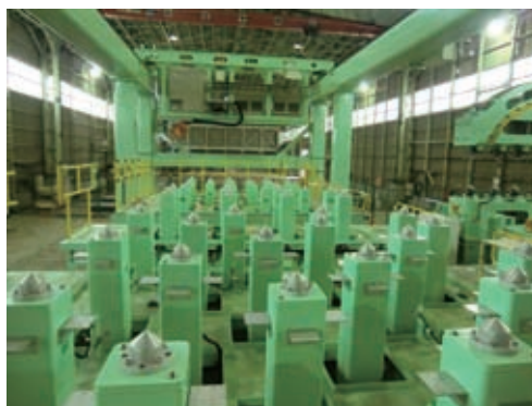
第11図 鋼板支持定盤
