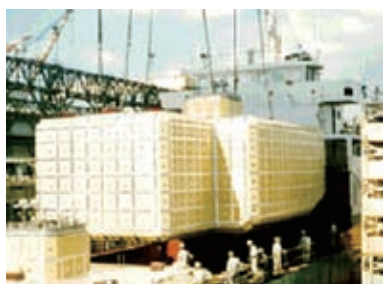
(b) LNG 船のタンク形状
