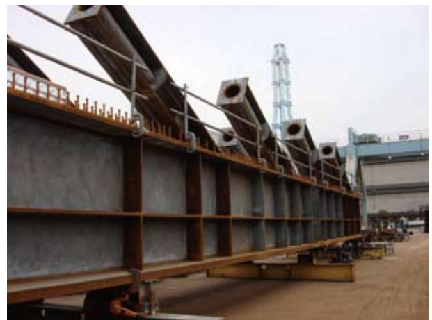
第5図 鋼桁 Fig. 5 Steel girders
