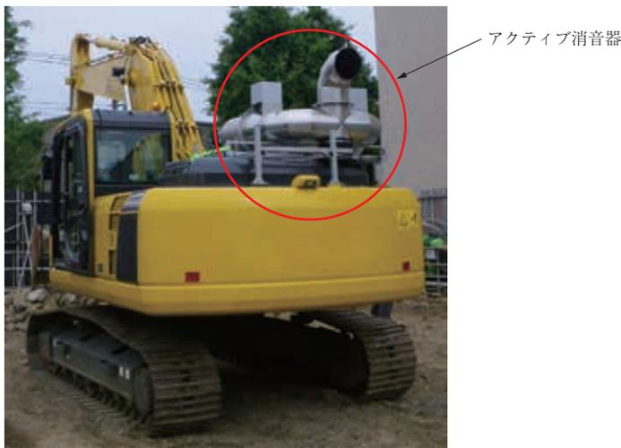
アクティブ消音器の搭載状況（試作機）
