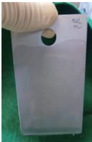
過酸化水素水ゲルの塗布状況
