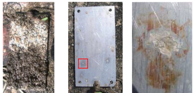
第 7 図 SUS304 試験片の海中浸せき結果 Fig. 7 Sea immersion result of SUS304 specimen
