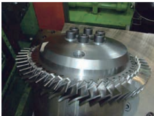
第 10 図 LFW で製造した圧縮機ブリスク (3) Fig. 10 Compressor blisk manufactured by LFW (3)
