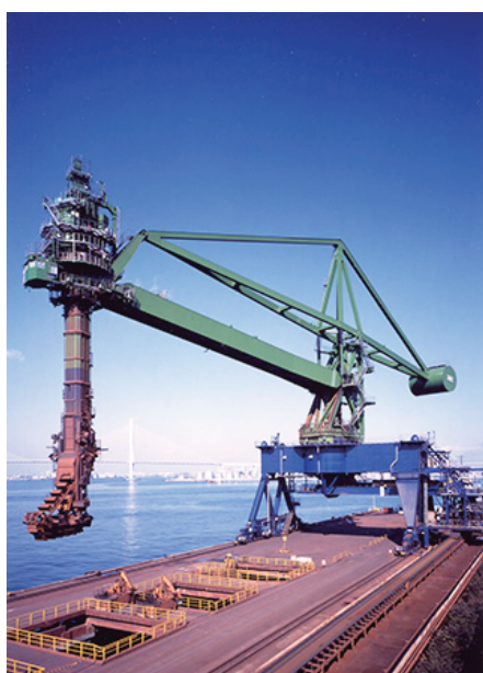
第1図 連続式アンローダ Fig. 1 Continuous ship unloader
