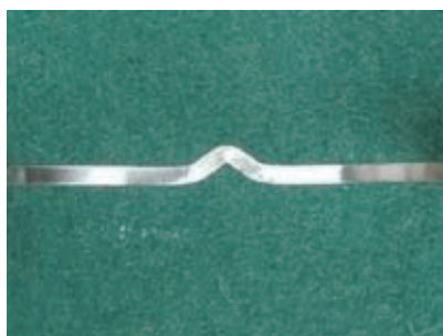
(c) Alloy82 の IDSCC 破面
