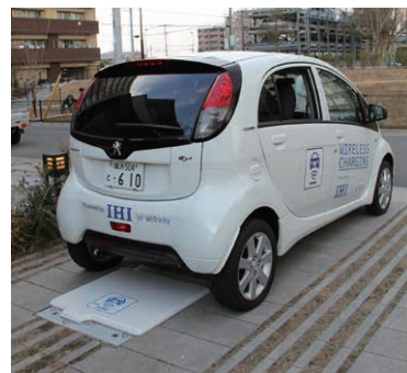
実証実験住宅における非接触給電装置 (三井ホーム株式会社 MIDEAS)
