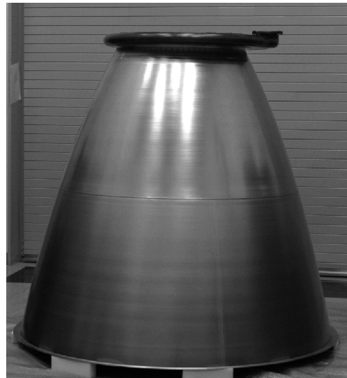
第 5 図 ノズルエクステンション Fig. 5 Extended nozzle
